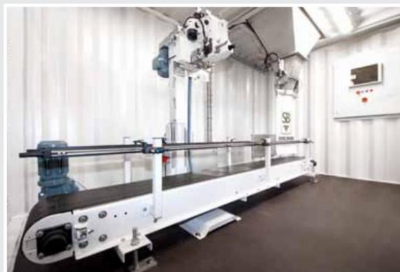
Füllklemme mit Abtransportband und Nähmaschine im Container
